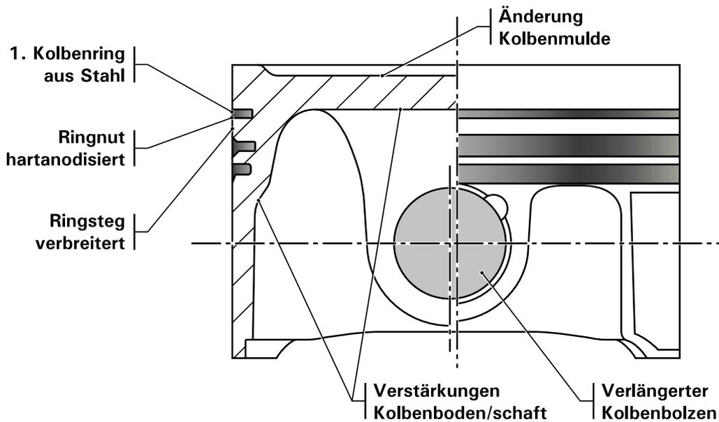
Abb. 3: Kolben-Modifikation
