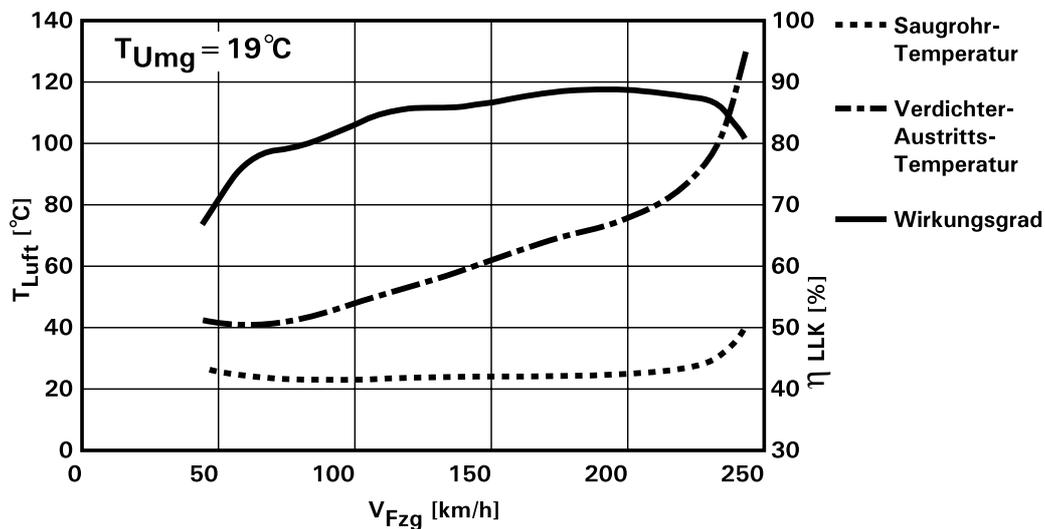
Abb. 6: Ladelufttemperaturen und Ladeluftkühlerwirkungsgrade im 6. Gang
